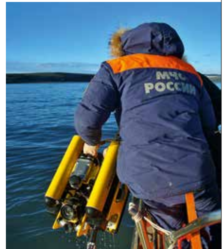
В работе использовался телеуправляемый необитаемый подводный аппарат «РовБилдер-600»
